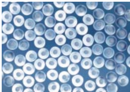
外径0.14mmの海水淡水化用中空糸膜
